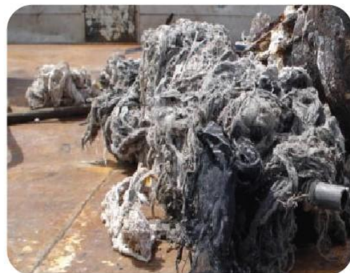
Déchets solides retrouvés dans les réseaux d'assainissement, à l'origine de bouchons et de débordements
